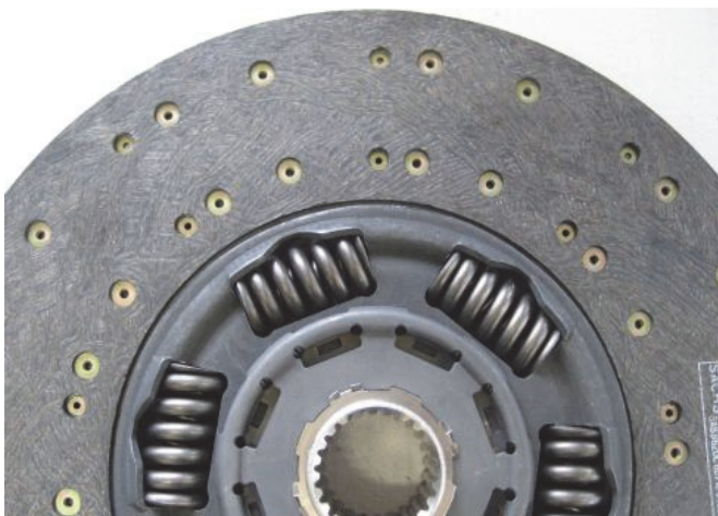
Fig. 3: Rivestimento lato ingranaggio
