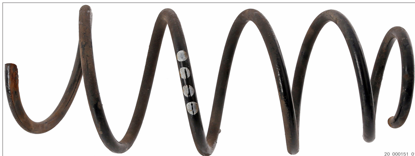
Fig. 2 Ressort de châssis usagé avec marquage par teinture (exemple)
