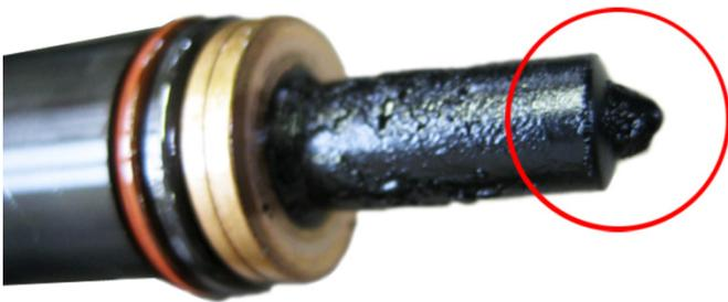
Fig. 3 : élément de l'injecteur de pompe cokéfié
