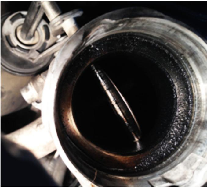
Fig. 4 : Couvercle de l'électrovalve de recyclage des gaz d'échappement (valve EGR) cokéfié
