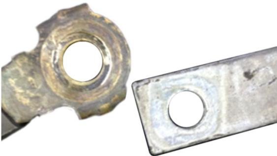
Fig. 1 : Mise à la terre avant le nettoyage : mauvais contact
