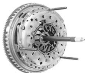
Fig. 10: Enlever l'outil de centrage d'embrayage et les goujons.
