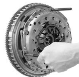
Fig. 11: Enlever le mécanisme d'embrayage et le disque d'embrayage.
