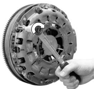
Fig. 30: Dévisser la pièce de verrouillage.
