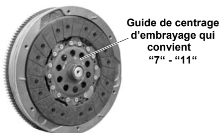
Fig. 29: Visser fermement le mécanisme d'embrayage.
