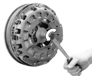
Fig. 31: Retirer le guide de centrage d'embrayage.
