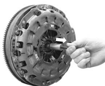
Fig. 31: Retirer le guide de centrage d'embrayage.
