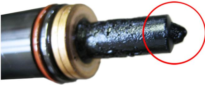
Abb. 3: Pumpe-Düse Element verkockt
