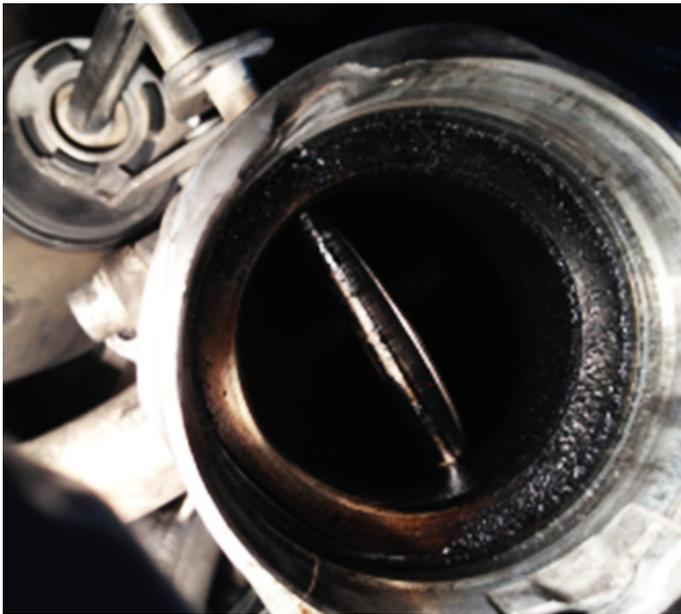
Abb. 4: Klappe des Abgasrückführungsventils (AGR-Ventil) verkocht
