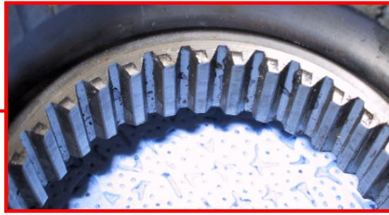
Dies geschieht, wenn die Zähne der Antriebshülse nicht in die Nuten der Nabe eingreifen, sondern gegen die Stirnseite des Nabenprofils gestoßen werden.
