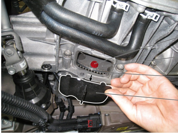
Abb./Fig 1: Abdeckung (5) demontieren / Remove cover (5) / Démontér le couvercle (5) / Desmontaje de la cubierta (5) الشكل 1: إزالة الغطاء (5)
