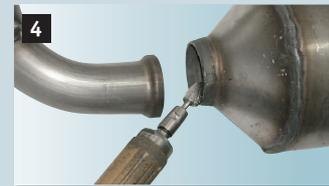
4 Schweißnaht mit dem „Schnellläufer“ auffräsen, bis sämtliche Reste vom alten Rohr entfernt werden können. Sorgfältig arbeiten!
