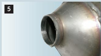
5 Wenn Öffnung am Konus gereinigt ist (alle Reste vom alten Rohr müssen entfernt sein), kann das neue Reparaturrohr problemlos eingeschoben werden.
