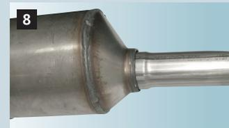
8 Das längere Reparaturrohr ca. 10 bis 15 mm tief in den Konus des KATS einschieben.
