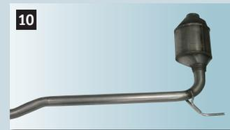
10 Clevere Reparaturlösung: Neues Reparaturrohr am funktionsfähigen „alten“ KAT.
