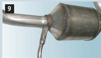
9 Neues Reparaturrohr verschweißen.
