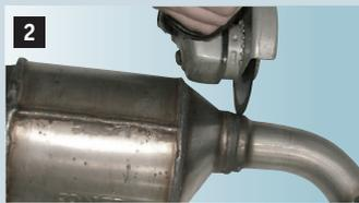
2 An der gekennzeichneten Stelle (hinter der Schweißnaht) altes Rohr mit der Flex abtrennen.
