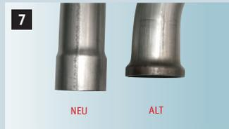
7 Neues Reparaturrohr ist länger als das alte abgeschnittene Rohr.
