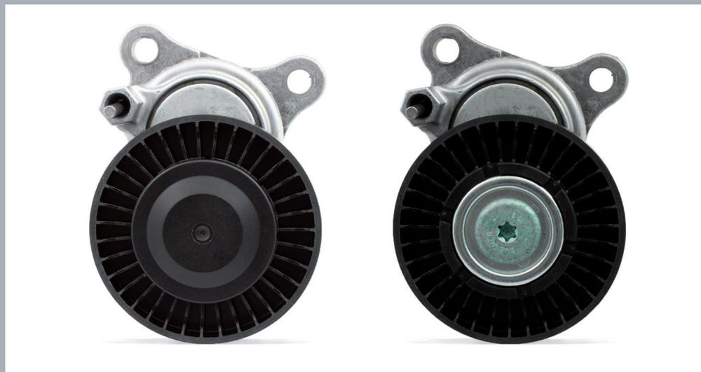
**Bild 1:** Links die alte Ausführung, rechts die neue Ausführung
