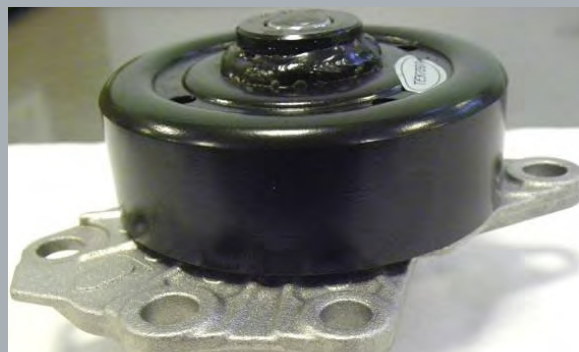
Bild 2: Wasserpumpe 66971 Aluminiumgehäuse (neu)
