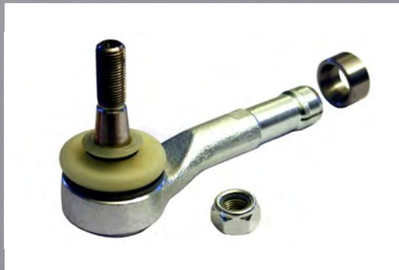
**Илл. 1:** 918619 – наконечник поперечной рулевой тяги с зажимным кольцом и гайкой
