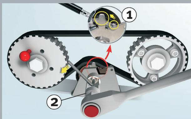
**Bild 1:** Trieb- und Positionsübersicht für Spannrolle und Spezialwerkzeug
