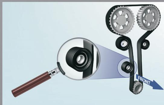
Bild 1: Riemenverlauf und Rollenpositionen im F4R-Motor
