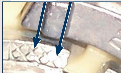
Beide Kerben stehen außerhalb der Aussparung (Pfeile). **Einstellung muss korrigiert werden!**
