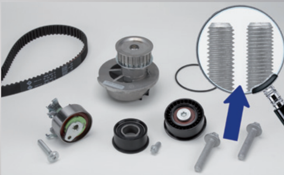
Bild 1: Beispiel am Wasserpumpen-Kit 55327731 mit beiden Ausführungen der Kurbelwellenschraube.
