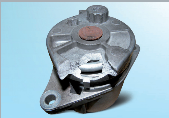
Bild 3: Beispiel eines gebrochenen Spannarmes 55123
