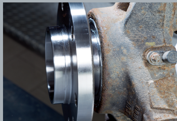
Bild 3: Der Sicherungsring muss bündig mit dem Achsschenkel abschließen
