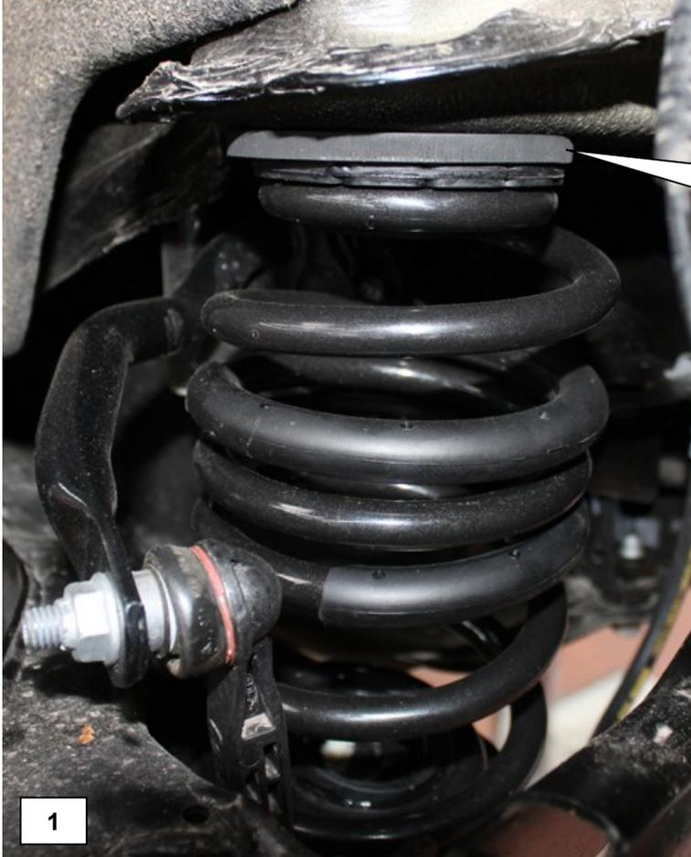
Die Gummiunterlage wird oben montiert.
