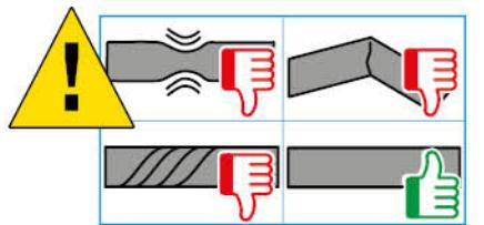
DE Leitung nicht beschädigen. | EN Do not damage the line. | ES No dañe el conducto. | FR Ne pas endommager la conduite. | EL Να μην προκαλείτε βλάβη σε αγωγούς και καλώδια. | ID Jangan merusak kabelnya. | JA 配線を破損しないようご注ください。 | MS Jangan rosakkan kabel. | PT Não danificar o cabo. | PL Nie uszkodzić przewodu. | ZH 不得损坏管线。| KO 케이블을 손상시키지 마십시오. | RU Не повредить кабель。 | TH ไม่ให้สายไฟชำรุดเสียหาย | TR Kabloya hasar verilmemelidir. | UK Уникати пошкодження проводів。 | AR عدم إتلاف التوصيل
