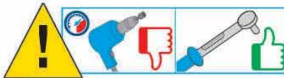
DE Keine Kraftwerkzeuge verwenden. | EN Do not use power tools. | ES No utilice herramientas de
