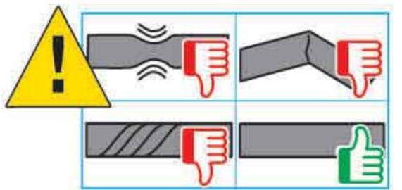
DE Leitung nicht beschädigen. | EN Do not damage the line. | ES No dañe el conducto.
