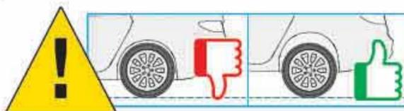
DE Nur bis Bodenkontakt ablassen. | EN Do not lower beyond the point of floor contact. | ES Suelte solo
