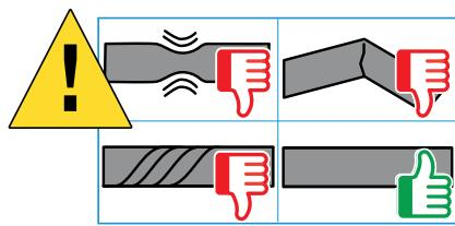
DE Leitung nicht beschädigen. | EN Do not damage the line. | ES No dañe el conducto.
