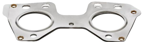
Il s'agit d'une part d'un système d'étanchéité métallique à trois couches doté d'une demi-moulure brevetée. Le matériau de base utilisé est Metaloseal™ L, d'ElringKlinger. D'autre part, un vernis de glissement à base de disulfure de molybdène / graphite est appliqué sur le côté tourné vers le collecteur d'échappement. S'y ajoute un liant en résine résistante aux hautes températures, principalement destiné à réduire l'usure par friction.
