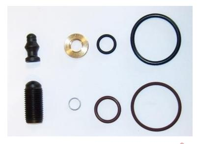
Se o pino esférico for trocado, é necessário trocar também o parafuso de ajuste. Por isso, o jogo de juntas, injetor 900.650 da Elring inclui ambos os componentes. A combinação de um parafuso de ajuste antigo e desgastado com um pino esférico novo aumenta substancialmente o risco de ruptura do pino esférico, para além de um forte aumento do desgaste. Por favor, evite a instalação de um parafuso de ajuste antigo em combinação com um pino esférico novo.
