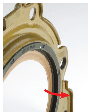
Figura 1 Labio obturador dirigido hacia la transmisión
