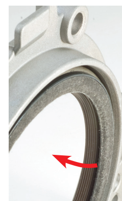
Figura 2 Labio obturador dirigido hacia el interior del motor
