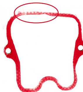
Figura 1 _Immagine della compressione con guarnizione VICTOR REINZ 70-26428-30 (OE 51.03905.0135)
