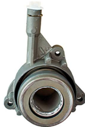
Imagen 2: Versión del CSC anterior 510 0092 10/11/12 con anillo de empuje metálico
