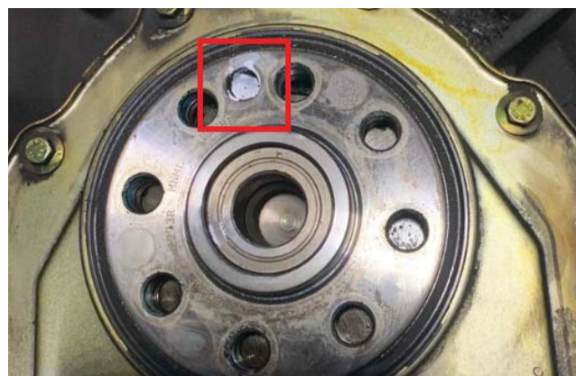
Slika 2: Položaj kontrolnog otvora na prirubnici kolenastog vratila
