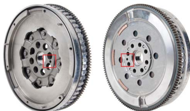
Slika 1: Položaj kontrolnog otvora na zamajcu
