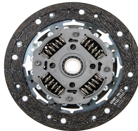
Fig. 2 : Le disque d'embrayage à pendule centrifuge LuK (côté boîte de vitesses)
