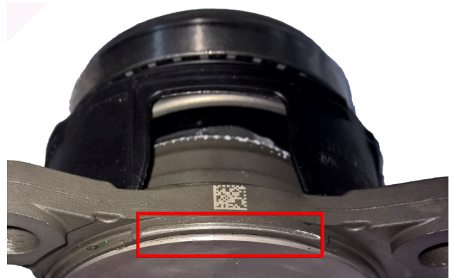
Зображення 2: Пошкоджений корпус гідравлічного витискного підшипника з демонтованою ущільнювальною шайбою
