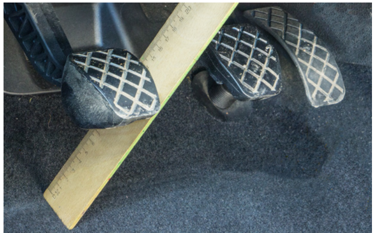
Figura 1: Dopo la sostituzione della frizione, è necessario regolare il gioco del pedale
