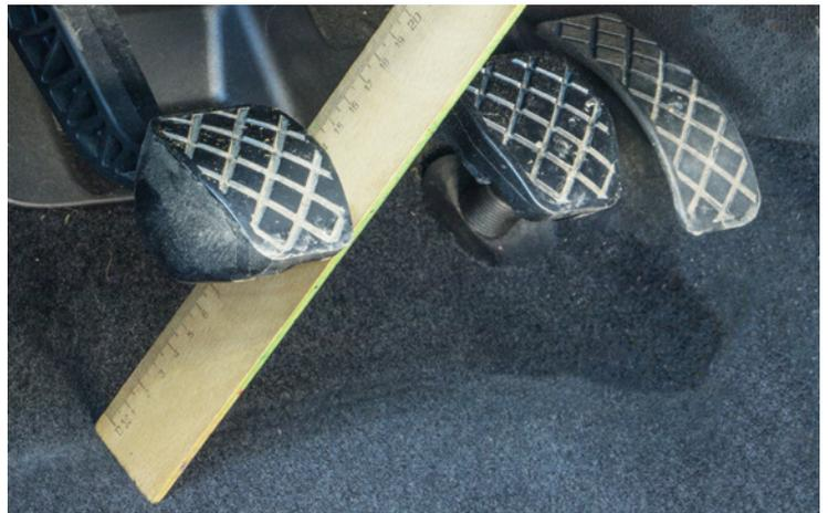
Photo 1 : Régler le jeu de la pédale après le remplacement de l'embrayage
