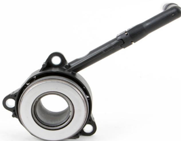
La butée hydraulique doit être purgée de son air selon une procédure déterminée.
