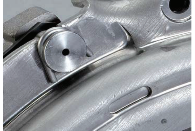
Resim 2: Kilitleme pimleri, stop pimleri ve debriyaj muhafazası arasına monte edilir.
