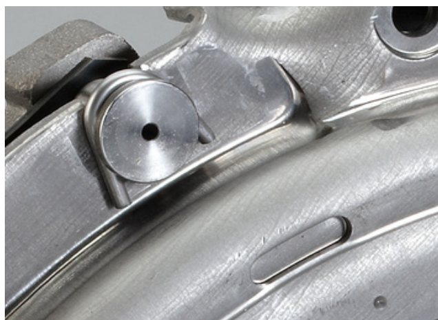
Bild 2: Monteringsbyglarna sätts in mellan stegbultarna och kopplingshuset
