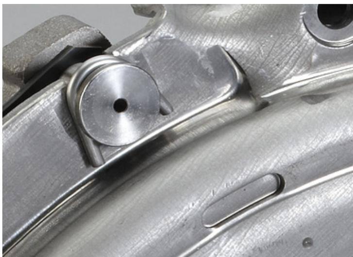
Figura 2: Le staffe di montaggio vengono inserite tra i perni guida e la struttura esterna dello spingidisco
