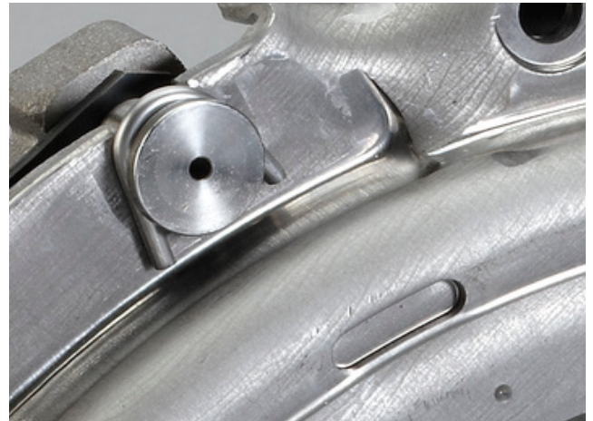
Εικόνα 2: Τα δεματικά είναι τοποθετημένα μεταξύ των τερματικών πείρων και του περιβλήματος συμπλέκτη
