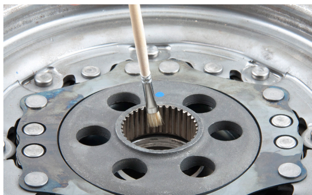
Fig. 1: Trebuie să se aplice puțină vaselină pe canelurile interioare ale VMD ori de câte ori acesta este servizat
