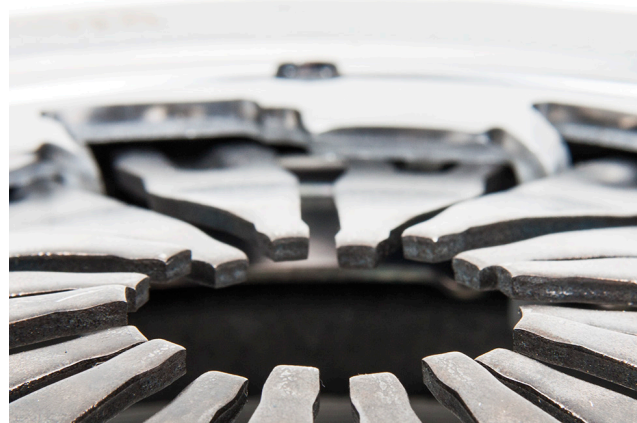
Рисунок 1: Неравномерность высоты пальцев диафрагменной пружины неустановленного сцепления
