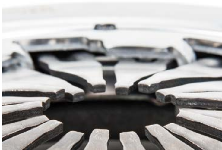
Foto 1: Różnice wysokości końcówek sprężyny talerzowej w niezamontowanym docisku
