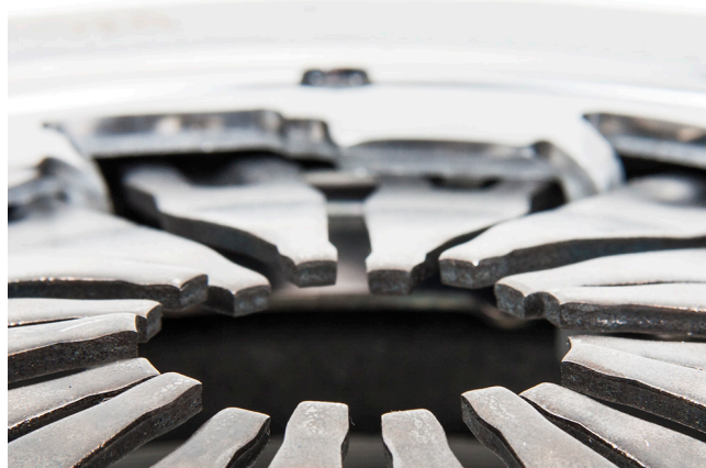
1. ábra: A tányérrugó nyelveinek elállítódása szétszerelt kuplungnál
