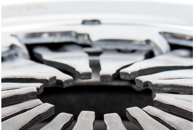
Photo 2 : Défaut d'alignement des lames du diaphragme d'un embrayage déposé
