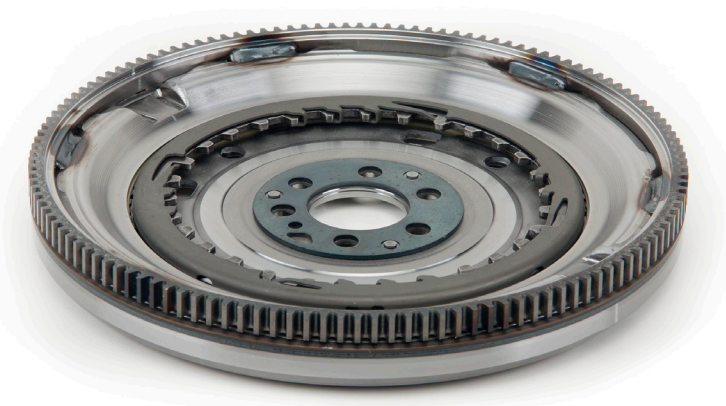
איור 1: מספר השיניים אשר על טבעת המתנע שעל חלק חדש חייב להתאים למספר השיניים אשר על החלק שהורד מהרכב
