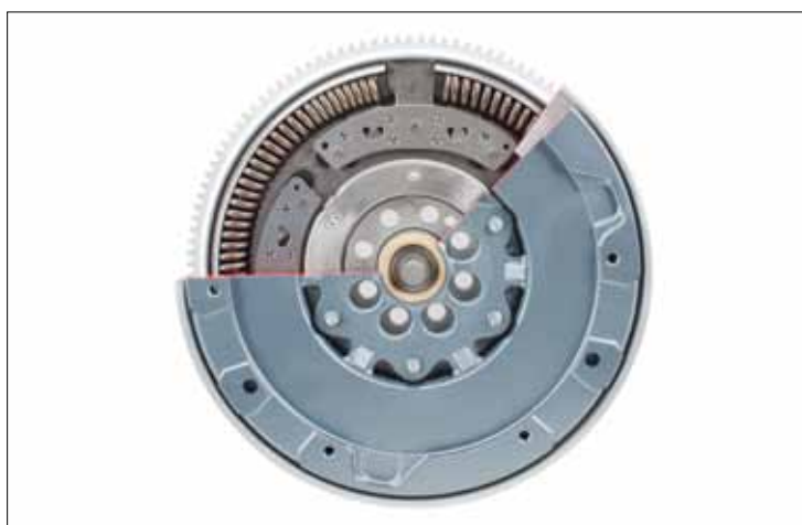
Slika 1: Zamašnjak podijeljene mase sa masenim njihajućim elementima za prigušenje vibracija
