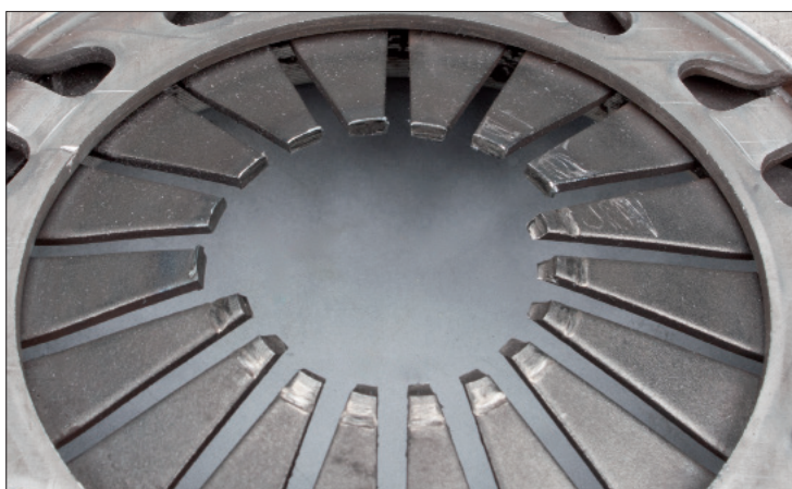
Bild 1: Skadad tallriksfjäder som följd av felaktig förspänning
