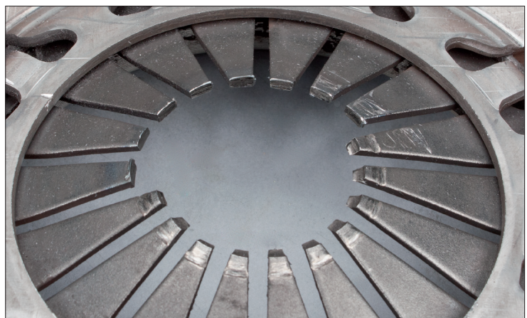
Fig. 1: Defecte diafragmaveer door ontbrekende voorlast
