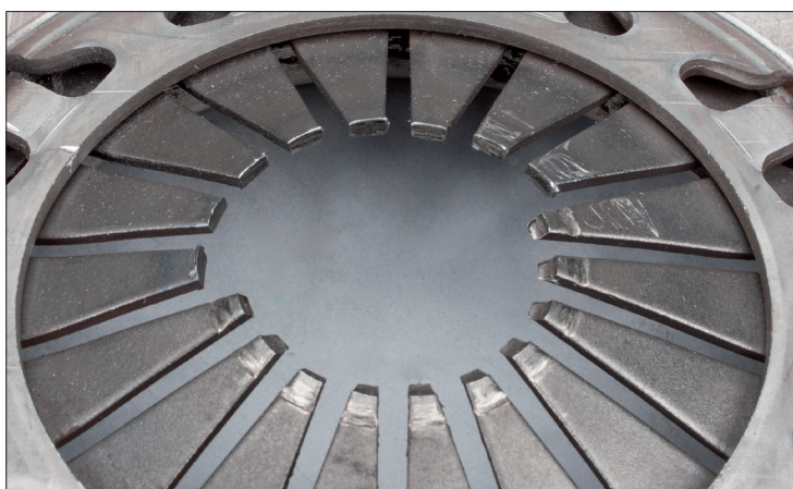
Photo 1: Diaphragme défectueux suite à l'absence de précharge
