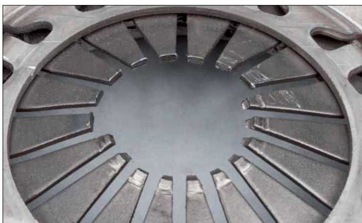
Figur 1: Fejlbehæftet membranfjeder forårsaget af manglende forbelastning
