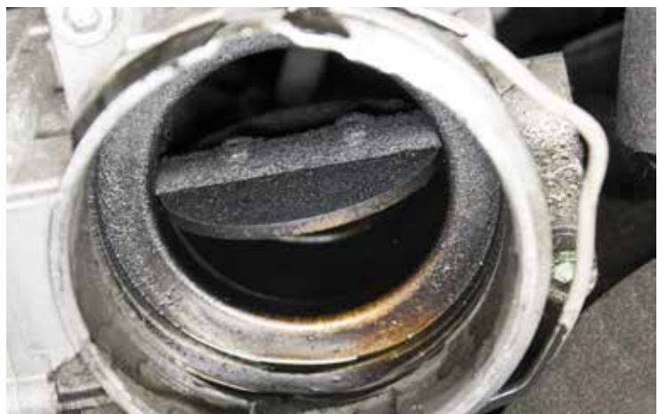
Slika 1: Odstraniti je treba vso nesnago v ohišju dušilne lopute
