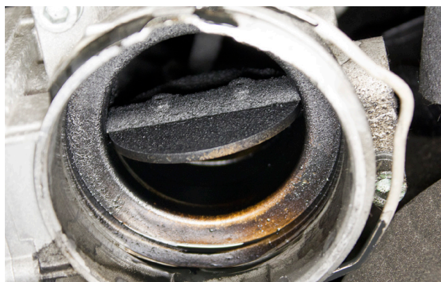
Fig. 1: Orice impurități găsite în carcasa clapetei de accelerație trebuie înlăturate
