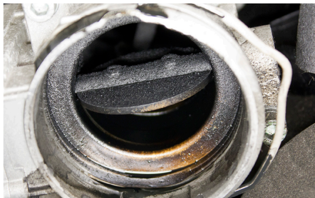
Снимка 1: Всякакви мръсотии от кутията на дросела трябва да бъдат отстранени.
